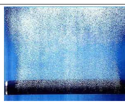
Aeração por difusor
