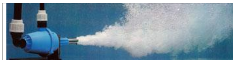
Funcionamento de um Venturi com bomba Submersa
