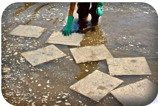
A Manta Absorvente SNatural tem a função de absorver óleos e hidrocarbonetos de derrames, seja em água ou solo, auxiliando na prevenção e remediação ambiental do setor industrial e diversos outros. Seu material é de alta qualidade e apresenta resultados de alta absorção, tem capacidade oleofílica e promove limpeza, controle e contenção de vazamentos de óleo.
