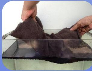
Colocando Almofada Absorvente sobre a camada de Óleo
