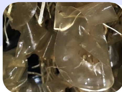
Biofilme formado na NAT250 em Tratamento de Efluente (esgoto doméstico)
