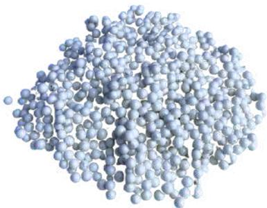
O Aluminat é um meio filtrante utilizado para remoção de flúor da água na forma de Fluoreto (F<sup>-</sup>). Utilizada em Água Potável, Água Industrial, Água de Reuso e Água Mineral.
