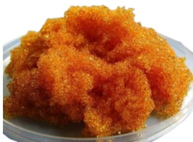
As Resinas de Troca Iônica servem para remover contaminantes iônicos da água. Podem produzir água potável e águas para uso industrial livres de contaminantes específicos que impediriam seu uso. As aplicações das resinas são determinadas pelo tipo de íon em sua composição. Promove desmineralização e abrandamento de água.
